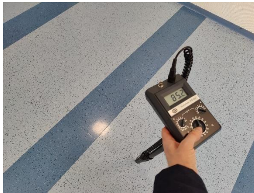
Käytävällä 163 havaittiin lievää kosteuspoikkeamaa. Syy ei selvinnyt.
